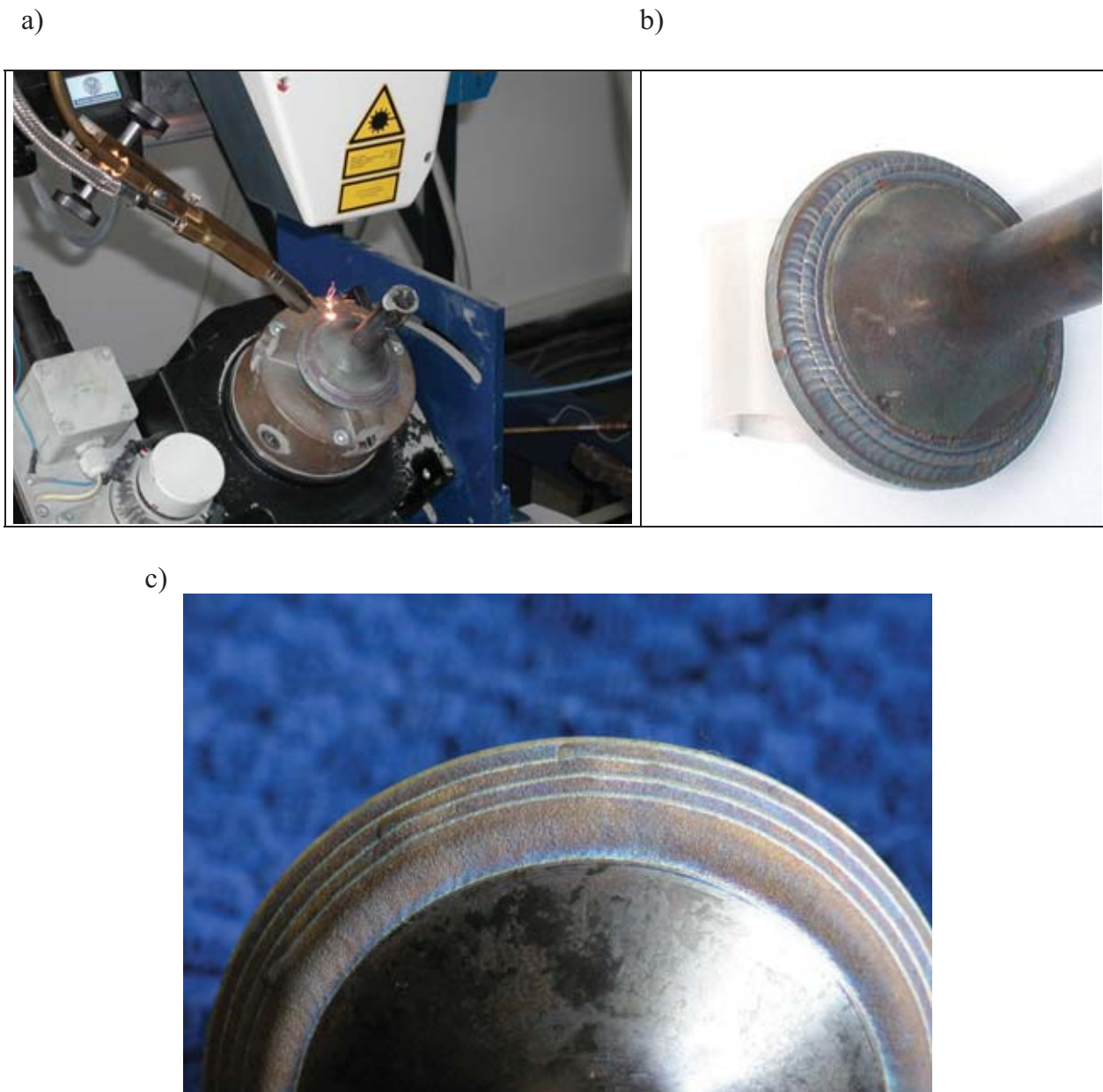
Rys. 4. Laserowe platerowanie (napawanie) przyłgni zaworów lotniczego silnika spalinowego oraz efekty technologiczne: a – widok ogólny stanowiska laserowego podczas platerowania zaworu, b, c –ogólny widok napawanej przyłgni zaworów wylotowych silnika
